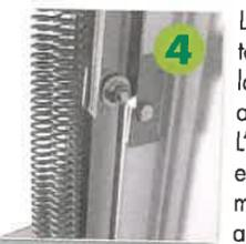
4 Les bras d'articulation supportent le tablier et en compensent le poids par la traction des ressorts hélicoïdaux en acier traité, largement dimensionnés. L'ouverture de la porte s'effectue sans effort, le débordement en cours de manoeuvre permet en outre de dégager au maximum l'intérieur du garage.
